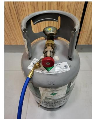
Niebieski wąż LP niskiego ciśnienia przykręcamy do przyłącza i zapinamy do szybko-złącza adaptera
